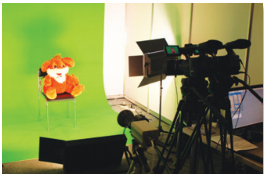
Две камеры (справа) снимают объект на зеленом фоне для интеграции в 3D-среду виртуальной реальности, сформированную с помощью студии «Фокус Стерео»
