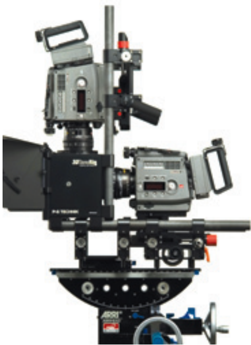
Платформа Standard Rig с камерами Sony F35 и Red One
