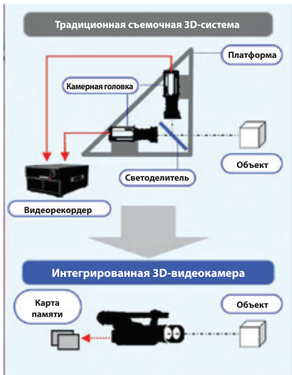
Сравнение традиционной 3D-системы и камеры AG-3DA1
