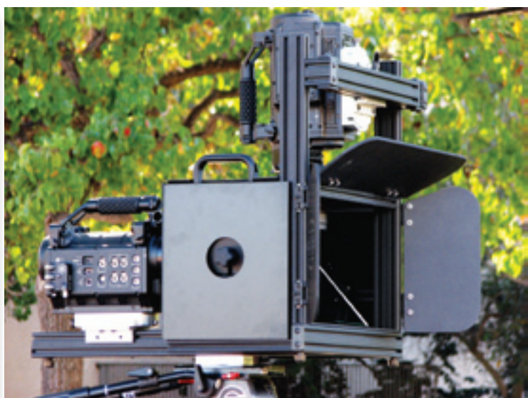
Платформа 3D-BS Pro Rig с установленными на ней камерами Red One
