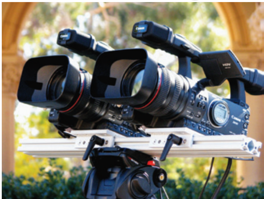
Камеры Canon на платформе 3D-SS Pro
